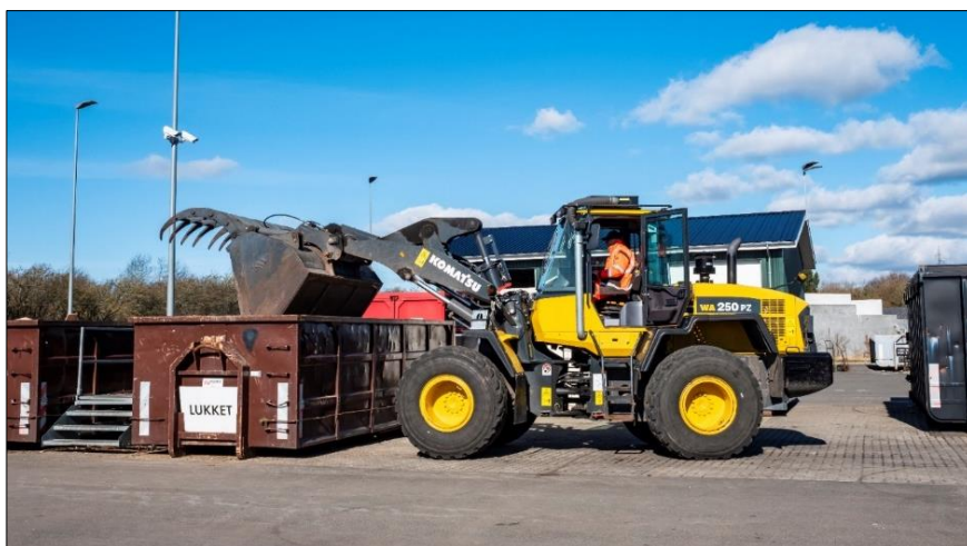
Foto: Affald trykkes, så det ikke fylder så meget i containeren.
